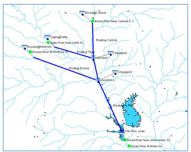
FIGURE 1 HEC-HMS MODEL CONFIGURATION
